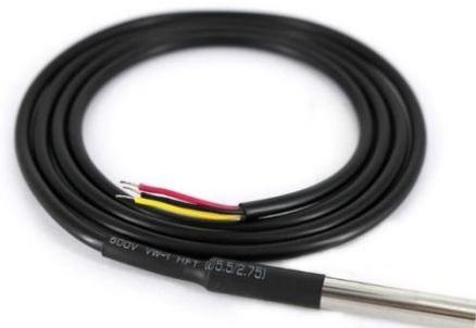
**Подключение.** Датчик имеет три провода, но подключается по двухпроводной схеме. Красный (*питание*) и чёрный (*земля*) провода соедините вместе и подключите к контакту **G** клеммника **GPIO**. Жёлтый провод **DQ** (*линия данных*) подключите к любому из контактов **P1-P4**. Питание датчик получает от линии данных (в «паразитном» режиме).
