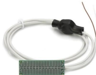
Подключение. Датчик имеет двухпроводную схему подключения: один провод подключается к любому из контактов **P1-P11** (“-”), а второй – к контакту **3.6V** (“+”). Полярность при подключении не важна. Пластина размещается в месте наиболее вероятного возникновения протечек.
