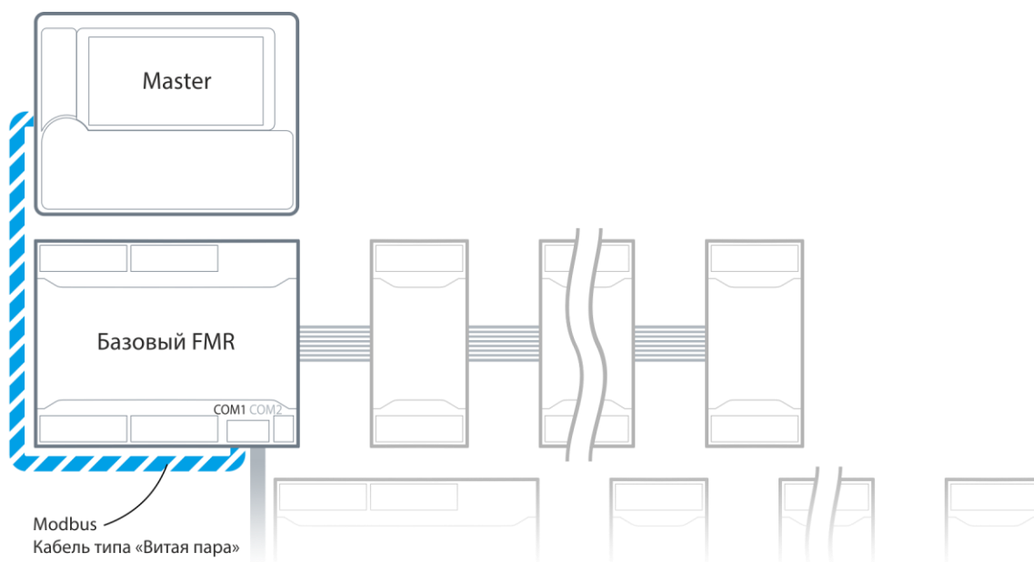
Рис. 26 - Подключение модуля FMR к контроллеру
