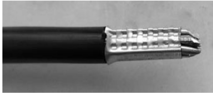
Рисунок 19 - Пример обжатия многожильного провода
