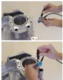
Рисунок 4: Методика измерения методом Leeb
