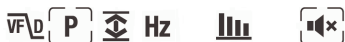
Рисунок 5.2 Значки режимов (измерения напряжения переменного тока): возможны режимы измерения пиковых значений и без звука
