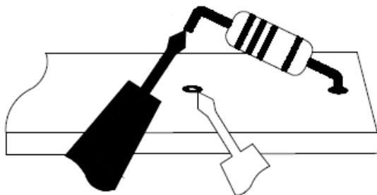
**Рис. 5.1.** Отсоединенный компонент
