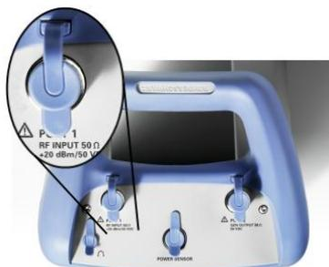
Подключите кабель или испытуемое устройство (ИУ) к ВЧ-входу с помощью N-разъема. Для подключения ИУ к прибору R&S FSH может потребоваться кабель.
