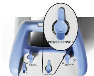
Этот разъем предназначен специально для датчиков мощности. Он используется как для питания, так и для обмена данными через интерфейс датчика мощности.
