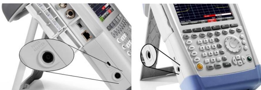
Через разъем питания постоянного тока прибор R&S FSH питается от сетевого адаптера питания (преобразователя переменного тока в постоянный). Разъем питания постоянного тока можно также использовать для заряда аккумулятора.
