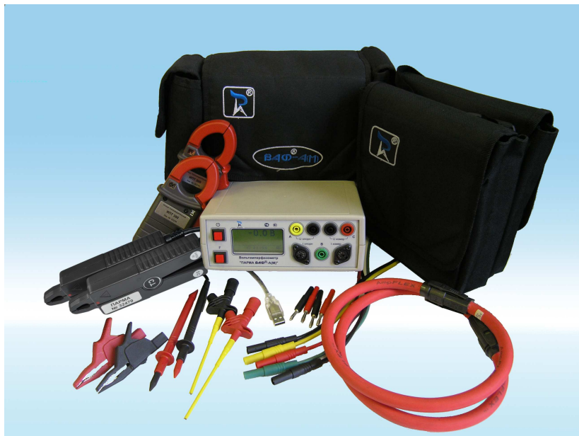
Внешний вид вольтамперфазометра “ПАРМА ВАΦ ® -А(М)” с принадлежностями
