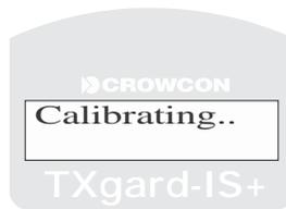
По завершении калибровки появится надпись: 'Calibration successful! Remove gas from the instrument --'. «Калибровка завершена успешно. Отключите газ».
