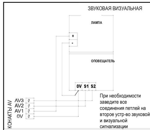
Рис. 2.16 Соединения AV
