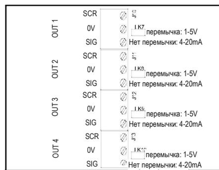
РИС 2.18 Аналоговые выходы панели Gasmaster
