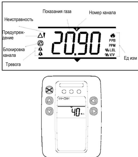
Рис. 3.2 Дисплей панели Gasmaster 1
