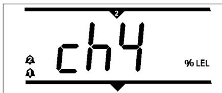
Рис. 3.3 Пример панели в состоянии тревоги
