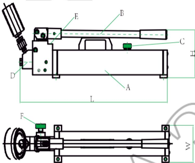
исполнительного механизма в бак осуществляется с помощью крана (F).
