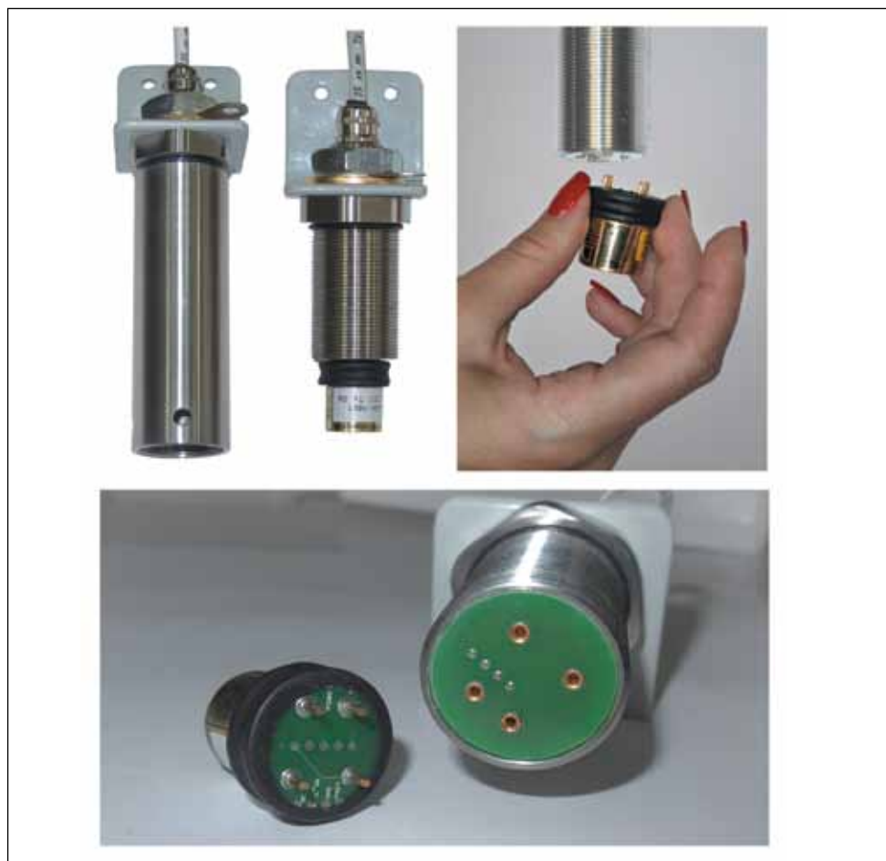
Рис.А5. Извлечение ИСМ из корпуса МКТ-1м
