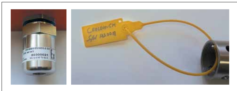
Рис.А7. Пример маркировки установленного ИСМ: а) с использованием самоклеящейся этикетки, б) с помощью подвесной бирки
