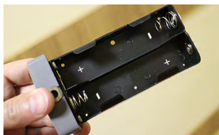
б) Вставить батарейки, соблюдая полярность
