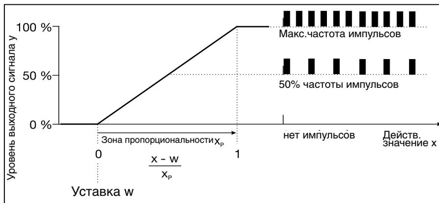
Если действительное значение  $x$  превышает уставку  $w$ , П- регулятор регулирует пропорционально величине отклонения. При превышении зоны пропорциональности регулятор работает с уровнем выходного сигнала 100% (максимальная частота переключения).
