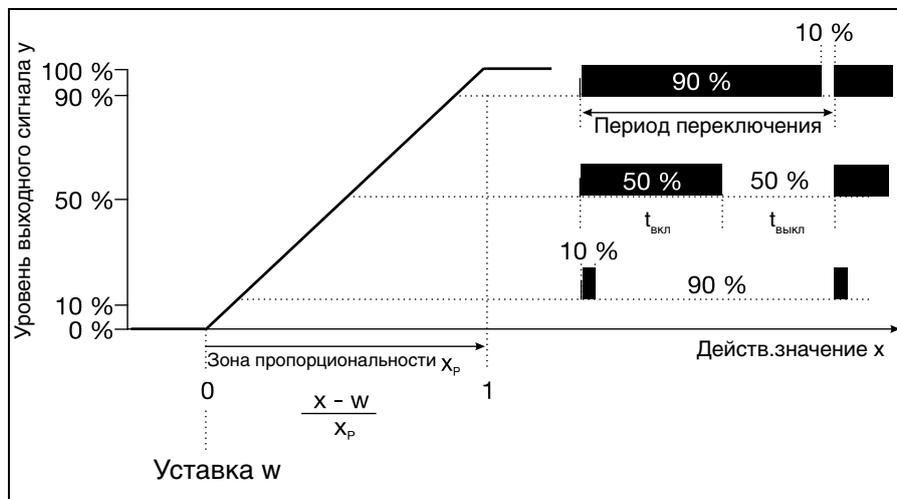
Если действительное значение  $x$  превышает уставку  $w$ , П- регулятор регулирует пропорционально величине отклонения. При превышении зоны пропорциональности регулятор работает с уровнем выходного сигнала 100%.
