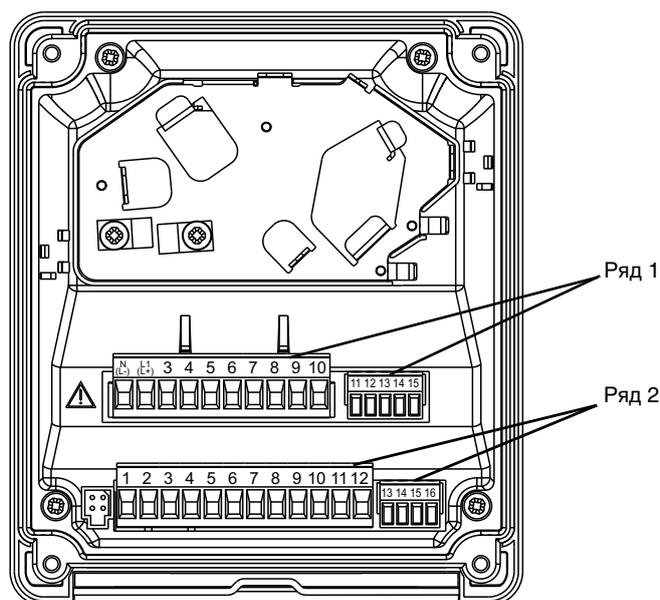
В качестве соединения между сенсором и измерительным преобразователем должен использоваться специальный коаксиальный кабель диаметром макс 8 мм. В приборе находится направляющая металлическая панель, позволяющая оптимально проложить соединительный кабель. Кабель проходит через герметичные кабельные вводы и подключается без применения пайки.
