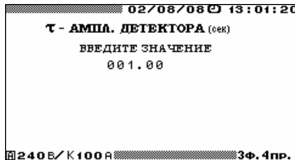
Рис. 4.8.13. Окно задания постоянной времени для режима «АМПЛИТУДНЫЙ ДЕТЕКТОР»
