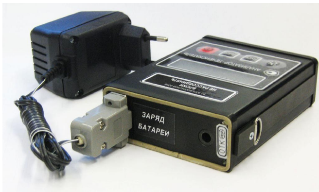
Рисунок 7.1. Подключение зарядного устройства к блоку ОИ.
