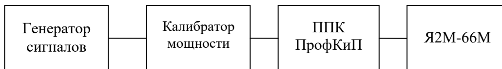
Рисунок 8 – Схема подключения приборов при определении погрешности измерения мощности
