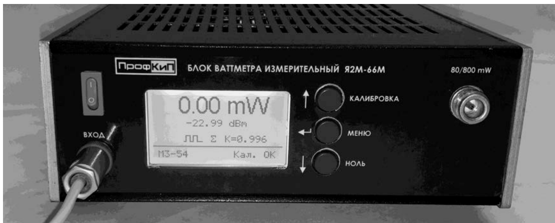
Рисунок 3 – Расположение органов управления и присоединения БИ на передней панели
