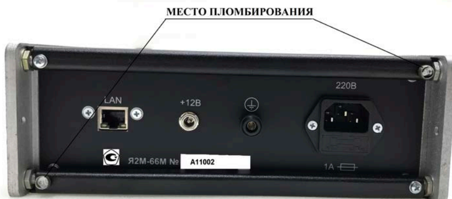
а) Схема пломбировки унифицированного измерительного блока (БИ),
