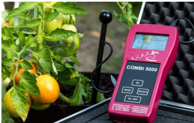
Одновременное измерение активности солей, влажности и температуры почвы с помощью мульти-зонда.
