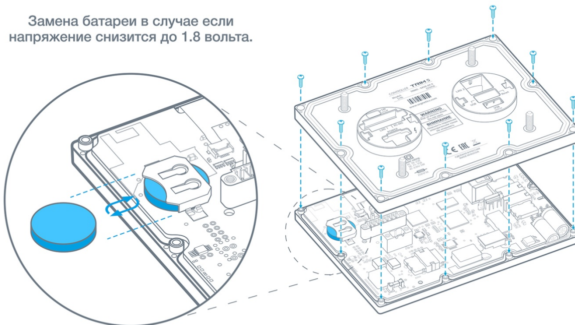
Рис. 15 - Порядок замены литиевой батареи
