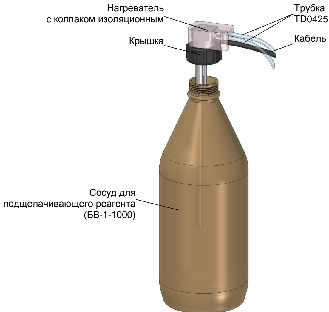
Рисунок 2.12 – Заливка подщелачивающего реагента в сосуд гидропанели ГП-1002Т
