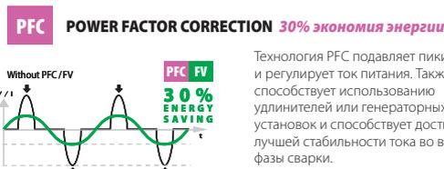
Технология PFC подавляет пики и регулирует ток питания. Также способствует использованию удлинителей или генераторных установок и способствует достижению лучшей стабильности тока во время фазы сварки.
