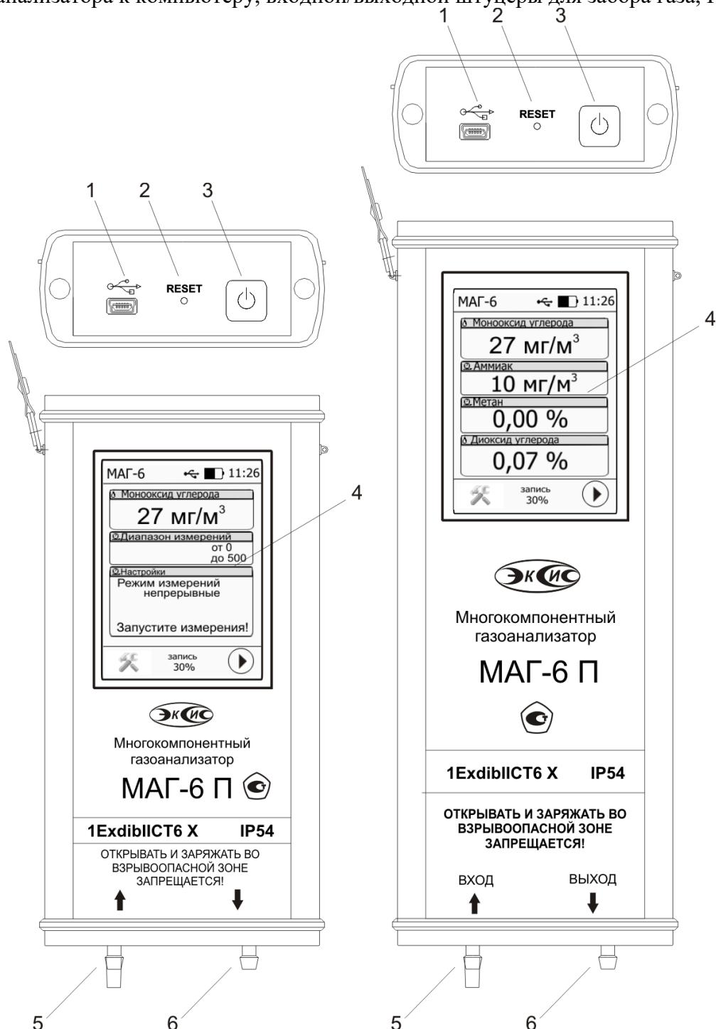
Рисунок 3.1 Вид газоанализатора МАГ-6 П-Т
