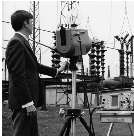
Рисунок 13.2 1969 г.:Thermovision модель 661. Эта камера весила около 25 кг (55 фунтов), осциллограф – 20 кг (44 фунта), а штатив – 15 кг (33 фунта). Кроме того, оператору требовался генератор переменного напряжения на 220 В и сосуд на 10 л (2,6 галлона)с жидким азотом. Слева от осциллографа видна фотоприставка Polaroid (6 кг/13 фунтов).
