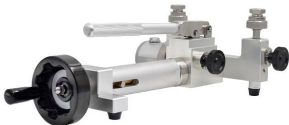
Пресс УСД-600В является вспомогательным оборудованием, применяемым для поверки и калибровки средств измерения давления методом сличения показаний эталонного и рабочего средств измерений. Пресс может использоваться как в полевых, так и в лабораторных условиях.
