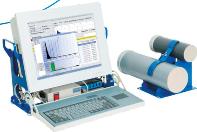
Установка предназначена для гамма-съемки местности и обычно включается в состав передвижной радиологической лаборатории.
