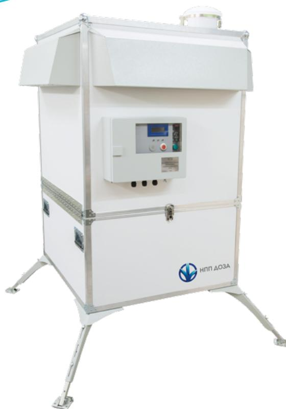
Непрерывная прокачка атмосферного воздуха с постоянным расходом через фильтрующий элемент на основе ткани Петрянова. Позволяет измерять параметры ионизирующего излучения в контролируемой точке в соответствии с возможностями используемого блока.
