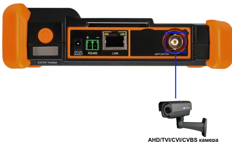
Рис. 10 Подключение AHD/TVI/CVI/ CVBS видеокамеры к тестеру
