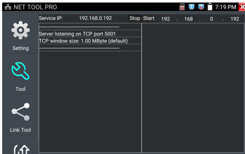
Рис. 90 Работа 1го тестера в режиме «сервер» при проверки пропускной способности сети
