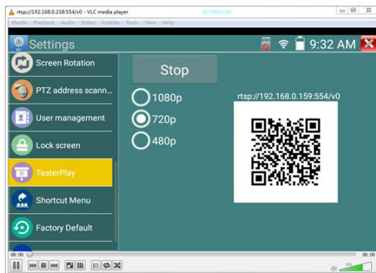
Рис. 23 Пример трансляции изображения на ПК с тестера с помощью VLC плеера
