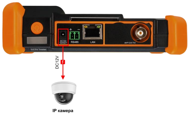
Рис. 9 Подключение питания к IP-видеокамере
