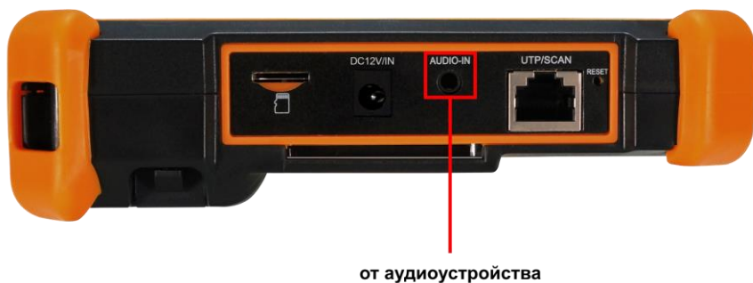
Рис. 12 Подключение тестера к аудиоустройствам
