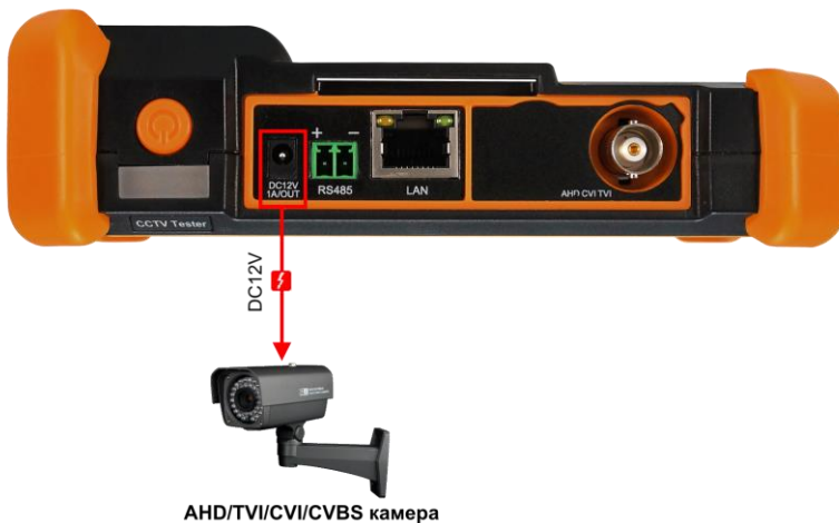
Рис. 4 Подключение питания DC 12V к видеокамере с использованием тестера
