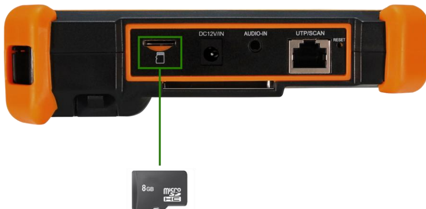
Рис. 23 Установка карты в Micro SD слот
