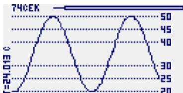
В верхней части экрана отображается масштаб текущего отображаемого кадра данных в секундах и положение этого окна в массиве накопленных данных.
