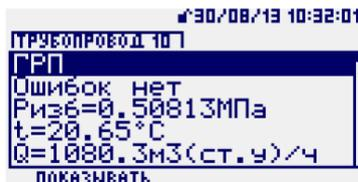
В меню просмотра состояния текущих параметров трубопровода после выбора курсором какого-либо параметра и нажатия кнопки *F1* (*показывать*) выбранный параметр будет отображаться на основном экране в строке соответствующего трубопровода:
