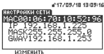
Для вычислителя в локальной сети Ethernet необходимо выделить фиксированный IP адрес и назначить маску подсети согласно выбранной сетевой конфигурации. Если у Вас вызывает затруднение назначение адреса или маски подсети для вычислителя, обратитесь к соответствующей литературе или к сетевому администратору Вашего предприятия.
