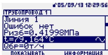
После установки курсора на параметре со значком ~ вход в режим просмотра графика выполняется кнопкой *ВВОД*. Пример вывода такого графика приведен ниже:
