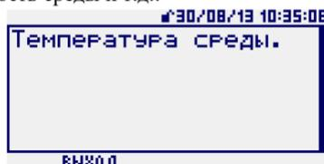
На индикаторе в корневом меню, где отображается список используемых трубопроводов, для каждого трубопровода выводится только один выбранный параметр. Выбор номера трубопровода и параметров и выполняется при помощи кнопок клавиатуры ▲, ▼, ►, ◀.
