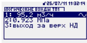
После установки курсора на параметре со значком **~** возможен вход в режим просмотра графика кнопкой **ВВОД**.
