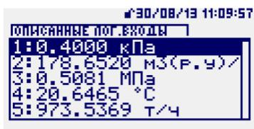
Возможен просмотр информации по выбранному параметру со значком ~ в графическом виде, в этот режим можно перейти путем нажатия кнопки *ВВОД*. Работа с графической информацией аналогична порядку, описанному выше в п.2.3.2.2.
