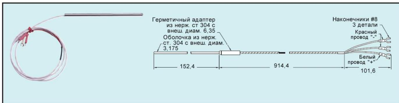
**Прецизионный ТДС** (Температурный датчик сопротивления) имеет превосходную точность и стабильность в широком температурном диапазоне. Доступны промышленные, стандартные 3-х проводные датчики с сопротивлением 100 Ом (DIN) с длинами оболочки 15 см, 30,5 см или 46 см и удлинительным кабелем 76 см, имеющим плоские клеммы.
