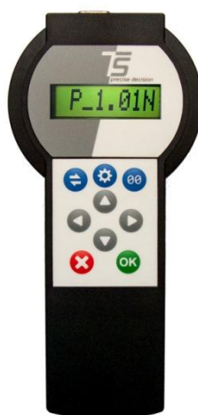
Рисунок 2 - Внешний вид пульта оператора с изображением версии программного обеспечения
