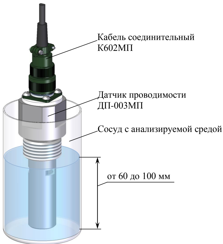
Рисунок 2.7 – Расположение датчика проводимости ДП-003МП в сосуде
