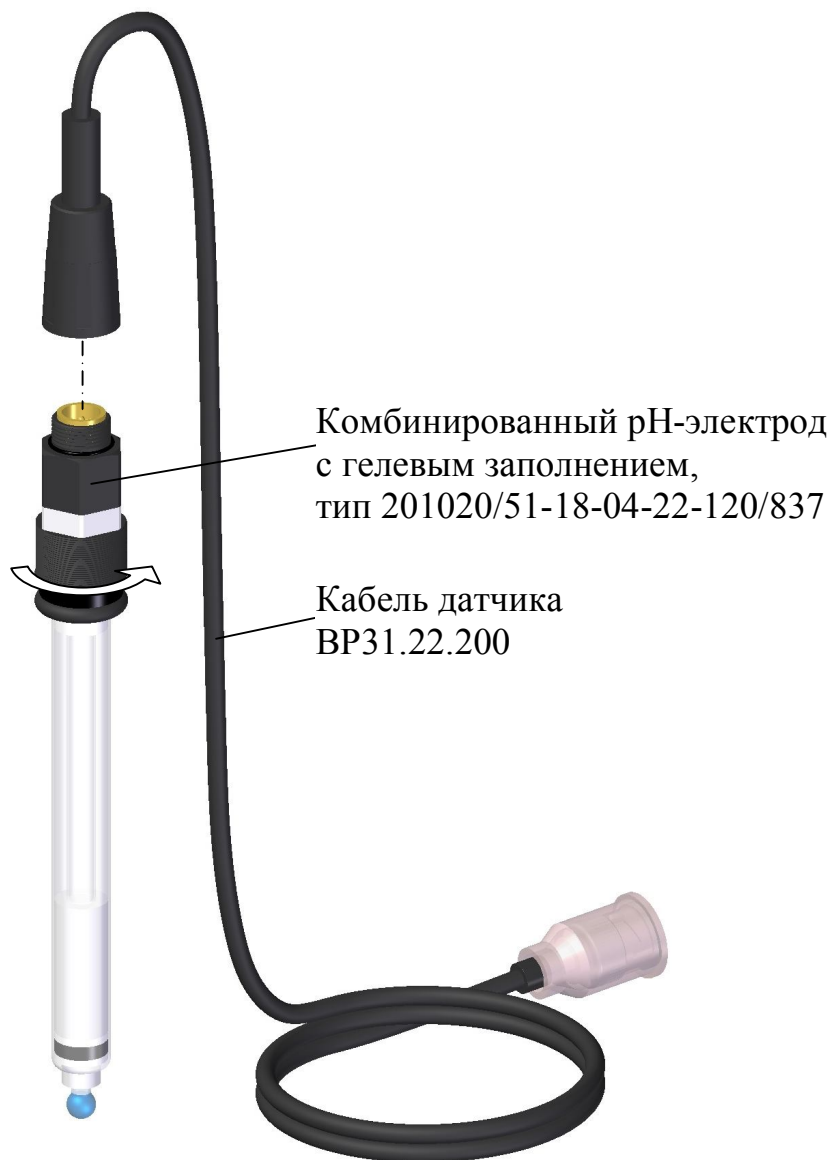
Рисунок 2.3 – Подсоединение кабеля датчика к электроду
