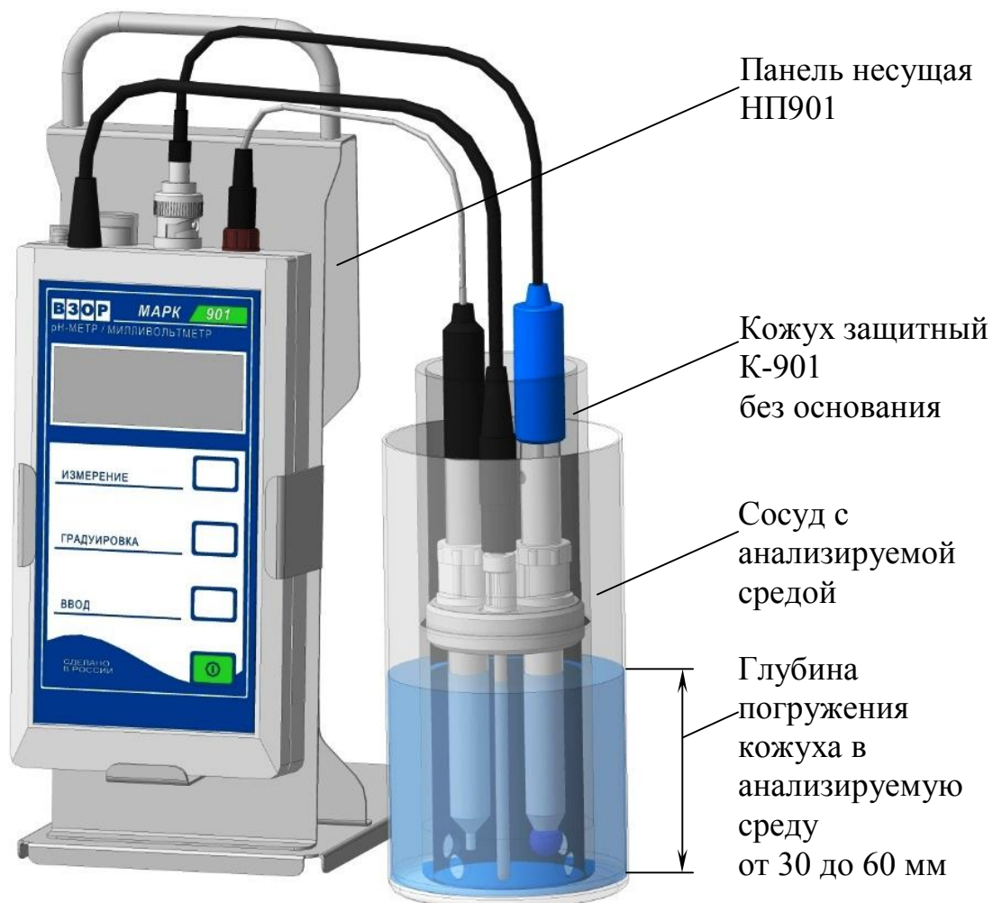
Рисунок 2.12 – Проведение измерений с использованием кожуха защитного К-901
