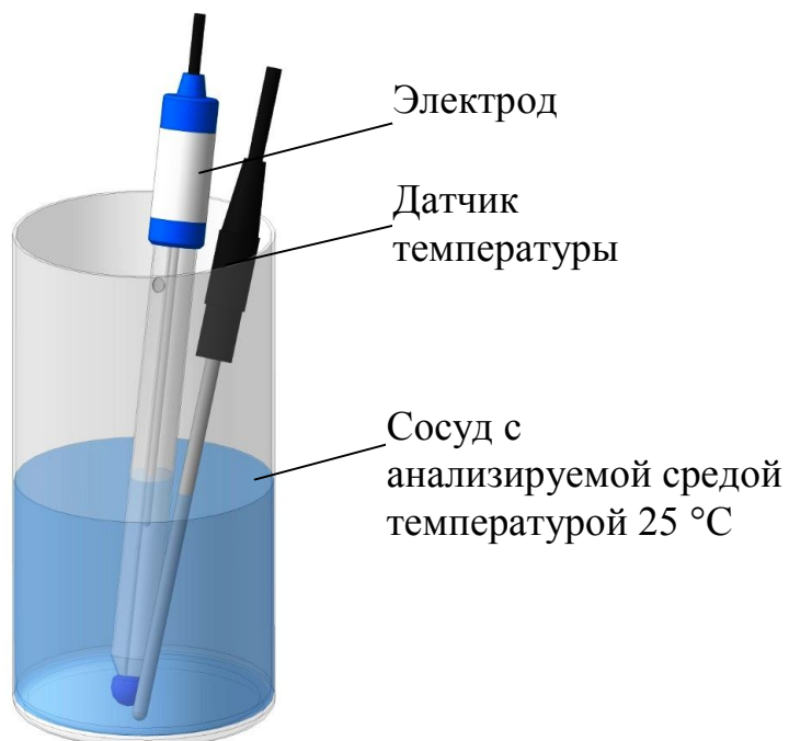
Рисунок 2.9 – Расположение комбинированного электрода и датчика температуры при проведении измерений (без дополнительного оборудования)
