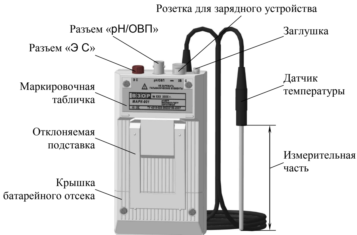
Рисунок 1.2 – Блок преобразовательный (вид сзади)
