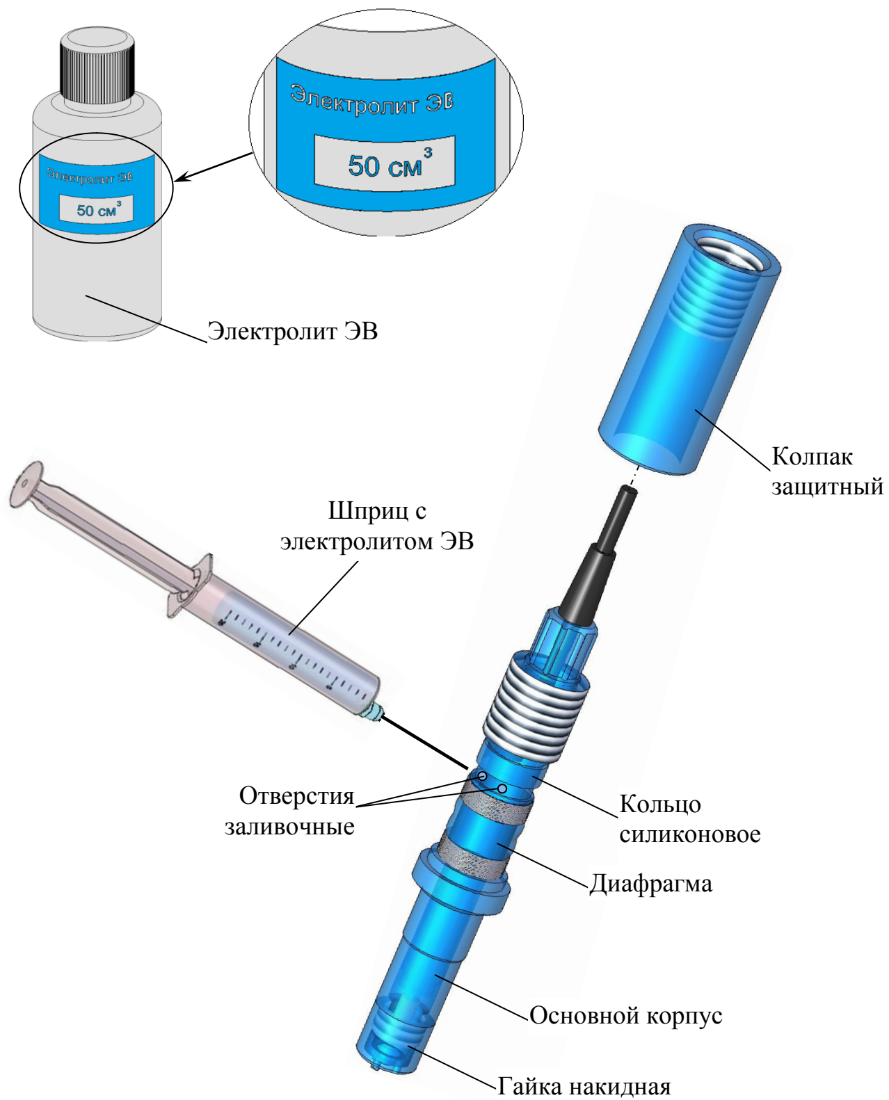
Рисунок 2.6 – Заливка (добавление) электролита
