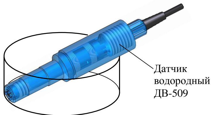
Рисунок 2.7 – Расположение датчика водородного ДВ-509 в среде с нулевым содержанием водорода (на воздухе)
