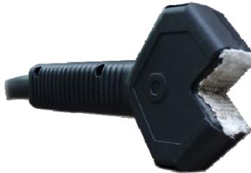
Индуктор для болтов используется для интенсивного нагрева ржавых или застрявших деталей, таких как болты и гайки. При использовании Индуктора для болтов для вывинчивания застрявших болтов и гаек можно сразу начинать с полной мощности. Другие виды использования включают удаление уплотнений с платформ грузовиков и задних частей седанов, а также пайку больших электрических соединений и формовку металла.
