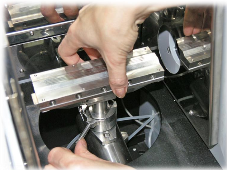
Рис. 41. Повернуть ручку механизма крепления по часовой стрелке до упора
