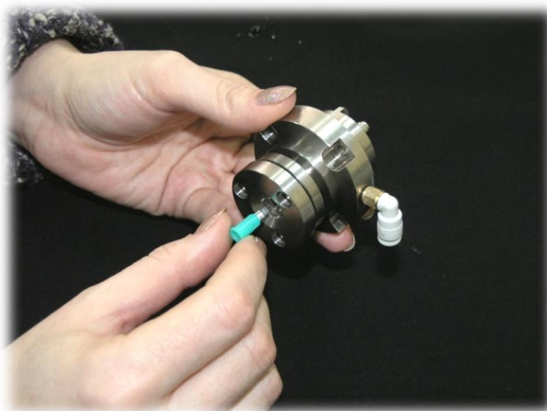
Рис. 74. Прочистка иглы распылителя с помощью приспособления
