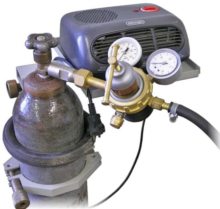
Рис.37. Подогрев редуктора при работе с закисью азота
