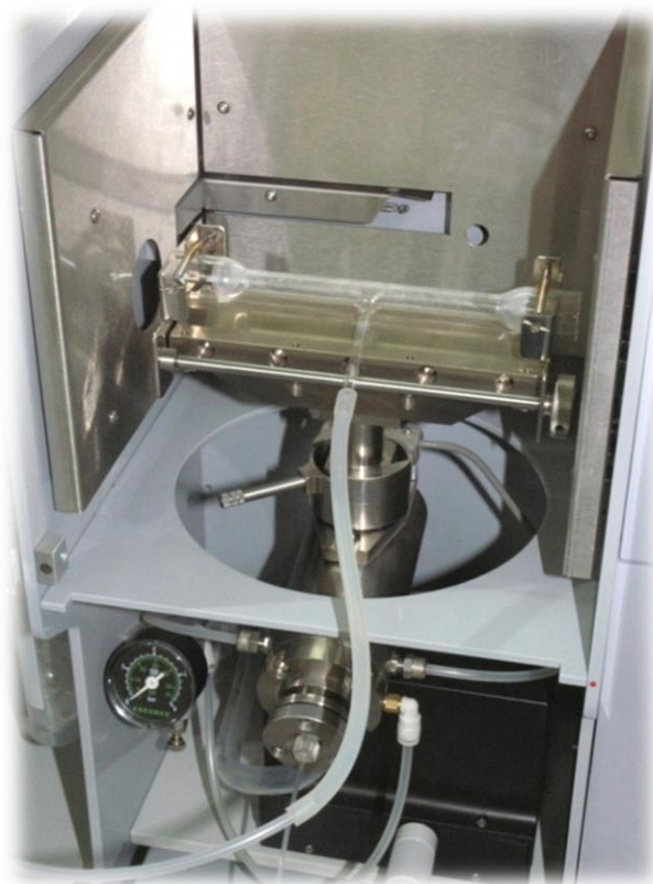
Рис.67. Установка кюветы с держателем на горелку.
