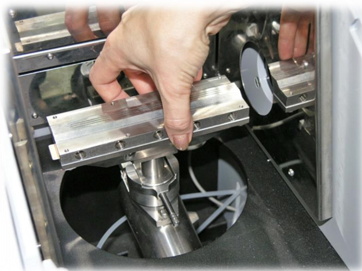
Рис. 40. Опустить горелку в зажим механизма
