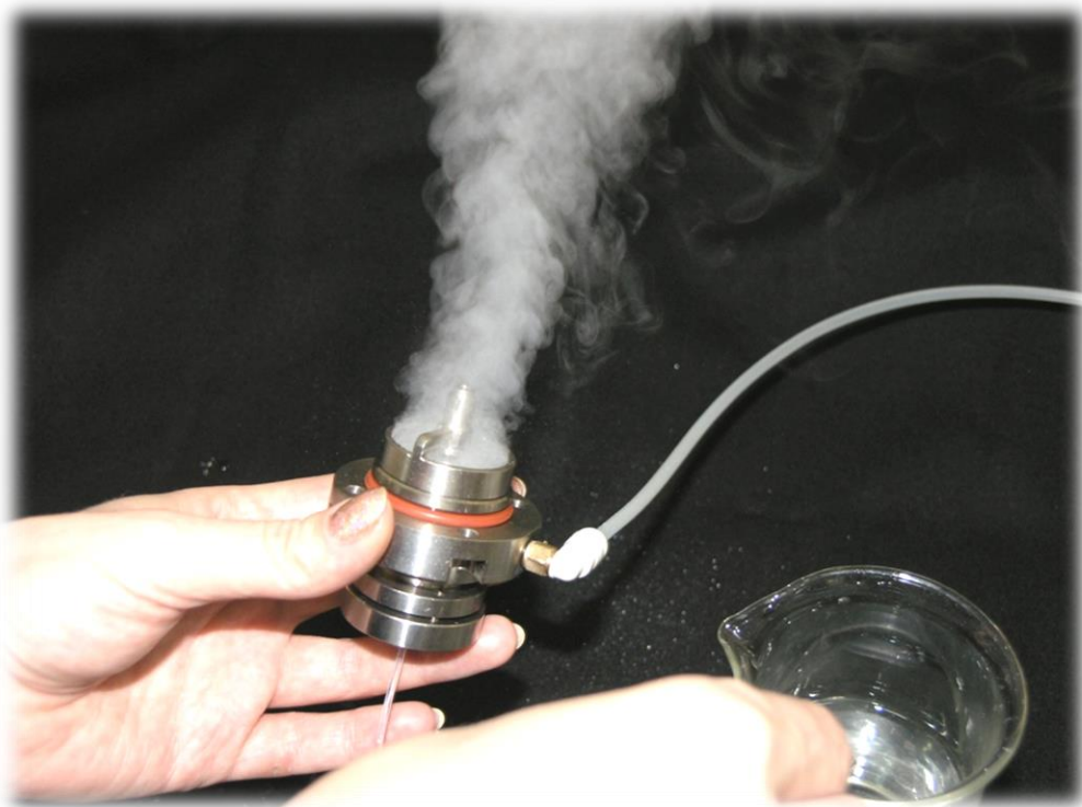
Рис.80. Проверка качества пыления
