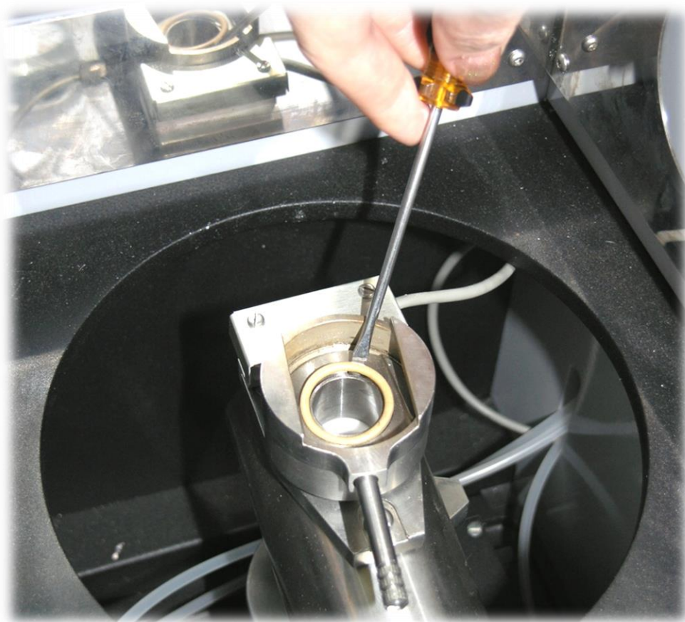
Рис. 72. Замена уплотнительного кольца камеры смешения
