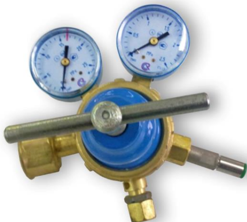
Рис. 34. Редуктор «БКО-50-4» – для аргонового баллона
