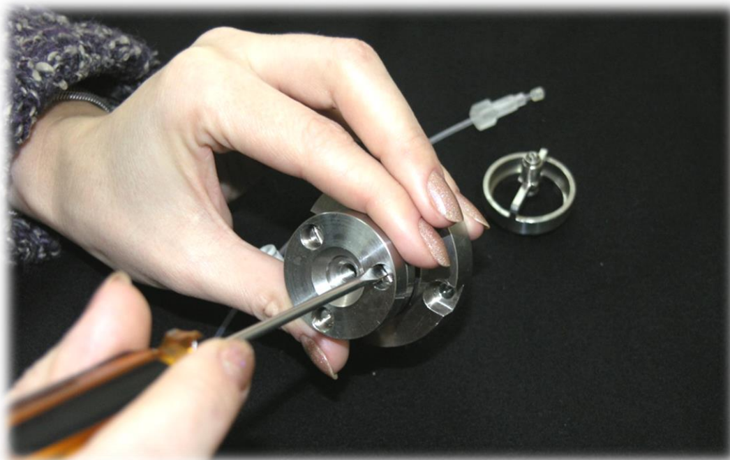
Рис.77. Снятие шайбы крепления иглы
