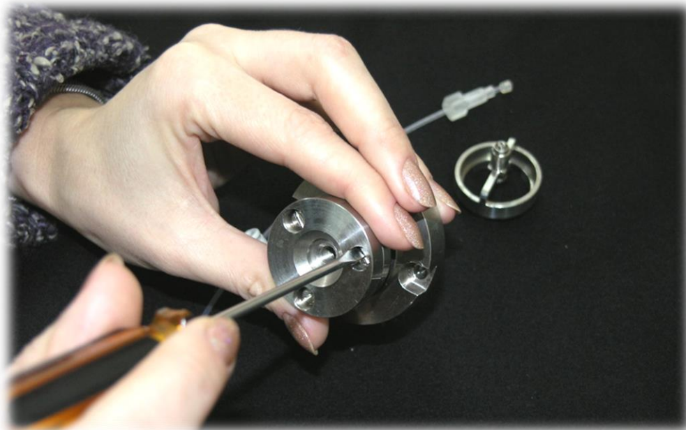
Рис. 79. Настройка расхода воздуха
