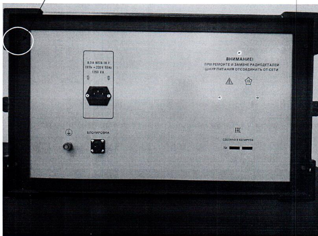
Рисунок 3.1 – Схема пломбировки от несанкционированного доступа
