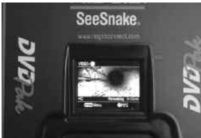
Рисунок 12 - Отображение сигнала с камеры на экране DVDR
