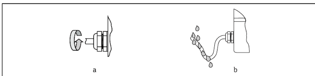
Рис. 40. Инструкции по установке кабельных вводов
