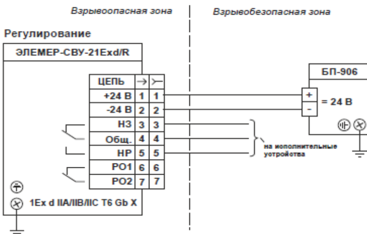
Рисунок Г.8 - Схема электрическая подключения сигнализаторов ЭЛЕМЕР-СВУ-21Exd с релейным выходным сигналом
