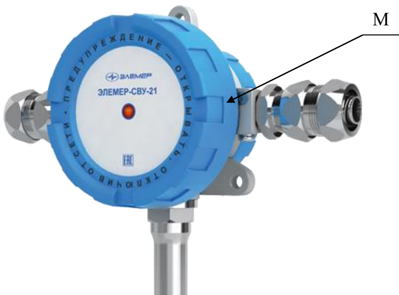
Рисунок 3.1 – Место приложения магнита при тестировании сигнализаторов (М)
