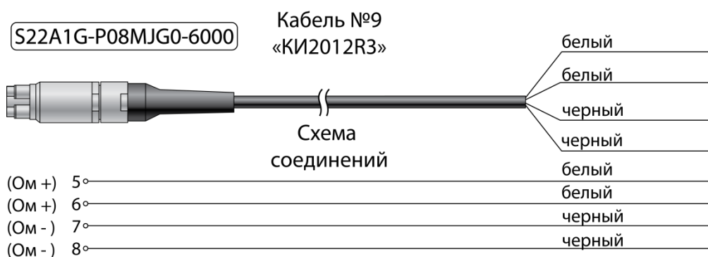
Рисунок А.13 – Соединительный кабель «КИ2012R3» для связи ИКСУ с устройствами по четырехпроводной, трехпроводной и двухпроводной схеме подключения в режиме воспроизведения сигналов от ТС и сопротивления постоянному току (для тестирования модулей «ЭЛЕМЕР-EL-2000»)
