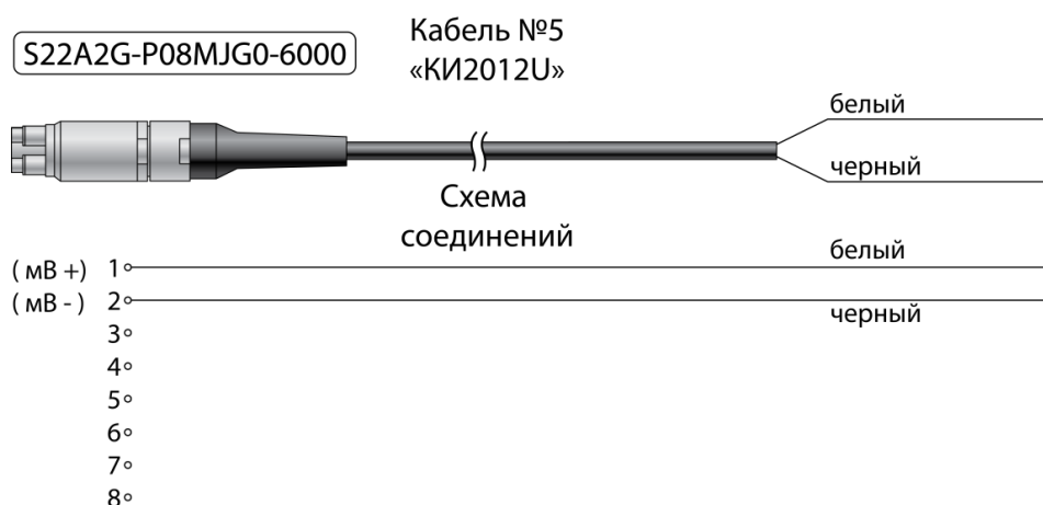
Рисунок А.9 – Соединительный кабель «КИ2012U» для связи ИКСУ с первичными преобразователями или устройствами при работе в режиме измерений напряжения постоянного тока, а также воспроизведения сигналов напряжения постоянного тока
