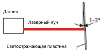
Рис. 23. Монтаж отражательных пластин
