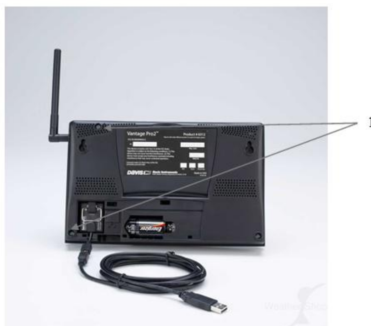
Рисунок 3. Схема пломбирования станции автоматической метеорологической Vantage Pro2. 1 – пломбы на модуле центрального устройства.
