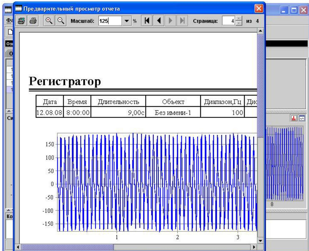
При нажатии на кнопку "Вычисление спектра", на экране появится окно, задав, в котором, параметры спектрального анализа, и указав интересующий участок сигнала, выполнить спектральный, октавный и третьоктавный анализ, нажав на кнопку "Вычислить".
