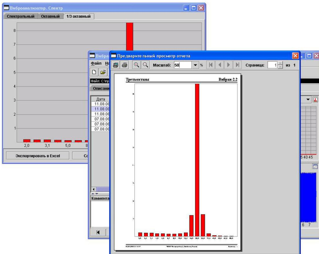
График сигнала, с возможностью детального просмотра интересующего участка, доступен для просмотра в отдельном окне. Для этого нужно щелкнуть мышкой по кнопке "График сигнала в отдельном окне".
