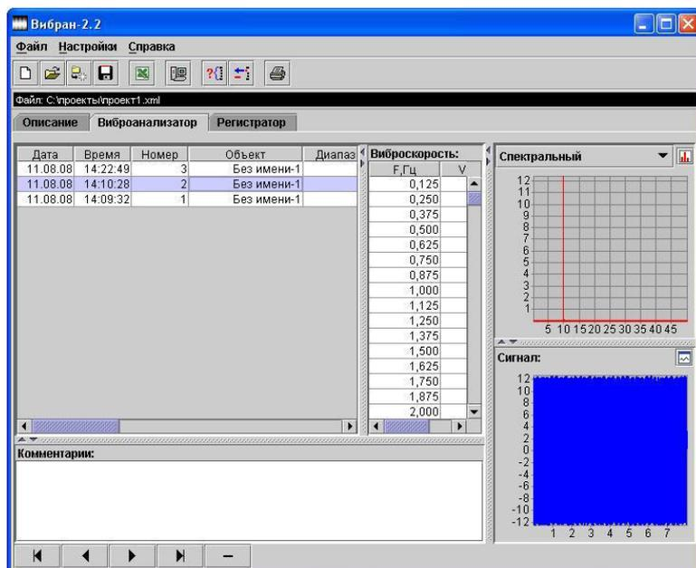
Изменив некоторые параметры (вид окна, тип спектра и измеряемый параметр: виброскорость или виброперемещение), выполнить другой спектральный анализ.
