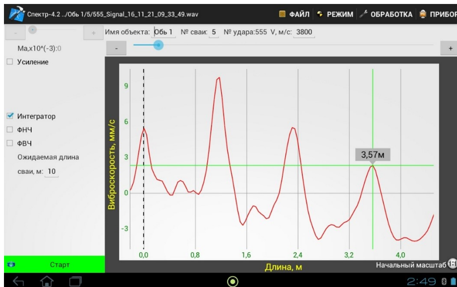
Рисунок 6.3 - Определение длины сваи
