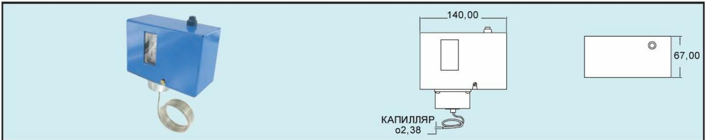
**Реле защиты от замерзания серии DFS** защищает охлаждающие змеевики в системах управления воздушных потоков, предотвращая рост инея на змеевиках. Чувствуя самую низкую температуру реле с переключателем DPDT (двухполюсный переключатель на два направления) с ручной или автоматической переустановкой дает сигнал на встроенную систему управления и также отключает вентилятор. Точки установки могут настраиваться на температуру 1 С. Для легкости установки серия DFS включает монтажный зажим.
