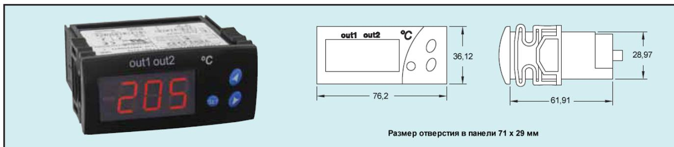
Двухступенчатое температурное реле серии TSS2 регулирует температуры для управления нагревом и охлаждением. Серия TSS2 сконструирована так, чтобы принять два входных сигнала и имеет независимые реле на выходе для двухступенчатого управления температурой. Серия TSS2 для удовлетворения требованиям заказчика имеет 34 программируемых параметра для реализации функций управления. Доступ ко всем параметрам, за исключением точек уставки, может защищаться паролем.
