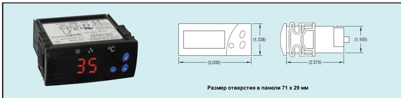
**Микропроцессорная серия TSX** является экономичным решением для приложений связанных с технологией охлаждения. Устройства сконструированы для приемки сигнала от двух температурных датчиков, которые могут выбираться из термисторов типа PTC или NTC. Температура от датчика показывается на ярком 3-цифровом СИД дисплее.
