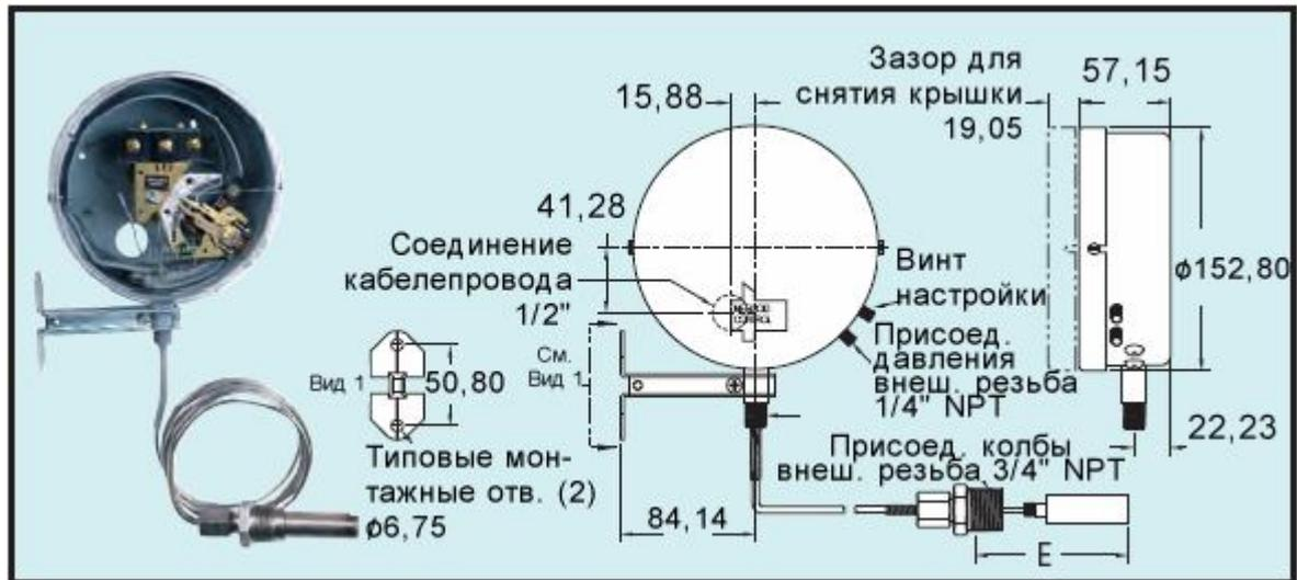
Температурные реле серии DA-7035N имеют тот же самый проверенный механизм переключения, используемый в нашей серии DA реле давления. Трубка Бурдона гарантирует высокую чувствительность и длительный ресурс работы. Полностью настроенная зона нечувствительности делает устройства подходящими для широкого диапазона приложений связанных с управлением. Хорошо видная, калиброванная шкала и внешние настройки делают изменения точек уставки простыми и быстрыми.
