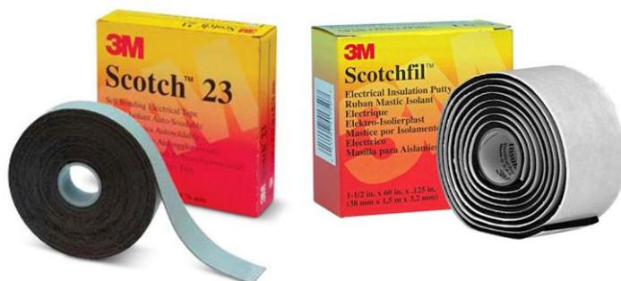
Для герметизации следует плотно, с натяжением при намотке и перекрытием намотать электроизоляционную мастику или самовулканизирующуюся клейкую ленту на разъёмное соединение (начиная с антенного кабеля и до самого корпуса модуля). Намотку осуществить сначала в одном, затем, не прерываясь, в другом направлении.
