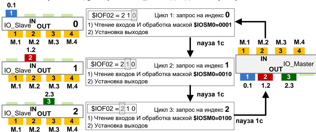
Таким образом, полный цикл работы модуля IO\_Master будет состоять из 3х запросов и 3х ответов. Если выключить флаг IOF23 и установить соответствующий параметр IOF15 для установки выходов, то цикл бы состоял уже из 12 пакетов (6 запросов и 6 ответов).
