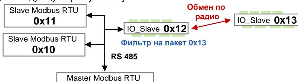
В существующую проводную систему необходимо включить удаленный и локальный модуль IO. Без фильтрации пакетов весь трафик между мастером и устройствами с адресами 0x10 и 0x11 передавался бы в эфир. После задания на модуле IO\_Slave с адресом 0x12 фильтр только на пакет 0x13, в эфире будут запросы только к модулю IO\_Slave с адресом 0x13. После этого останется только установить на мастере корректный тай-аут ожидания ответа с учетом задержки передачи данных в эфире.
