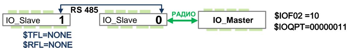
Модули с n0 и n1 опрашиваются по радио которые соединены друг с другом по RS485. Для модуля n1 также нужно отключить прием/передачу из эфира.
