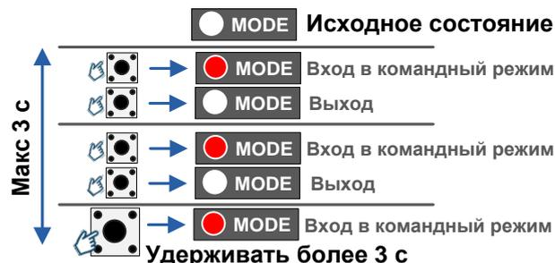
После этого, индикатор MODE начнет мигать в течении 3с. Если до истечения 3с отпустить кнопку, то модуль просто пересбросится. По истечении 3с модуль также пересбросится, но кнопка при этом будет нажата, что будет эмуляцией входа в режим загрузчика (как при включении питания с нажатой кнопкой CFG).
