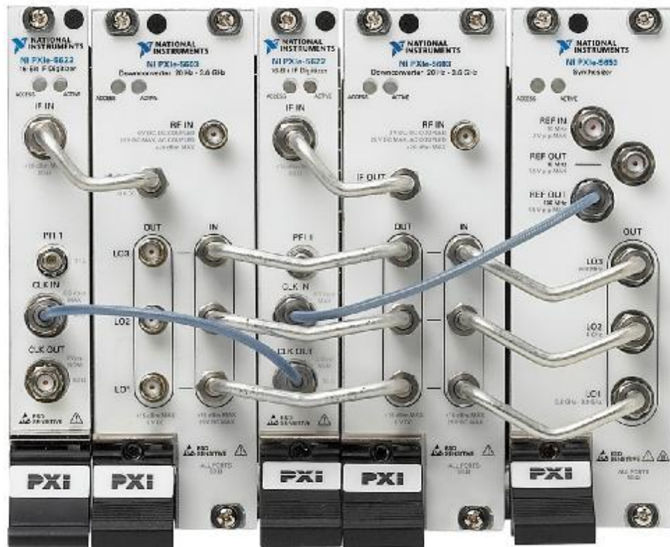
Фотография 2 - Схема соединений для 2-х канальной модели NI PXIe-5665 (3,6 ГГц)
