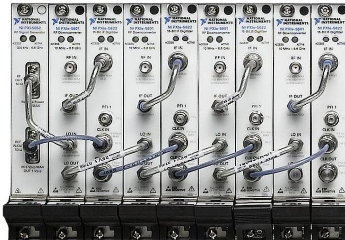
Фотография 1- Схема соединений для 4-х канальной модели NI PXIe-5663E
